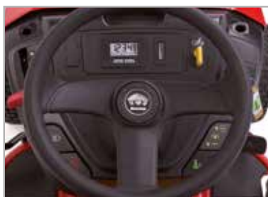
Mini Dash avec des informations quant aux heures de fonctionnement, à la tension de la batterie et à la nécessité d'entretien
