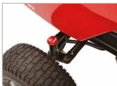
Robusto assale anteriore oscillante in ghisa
