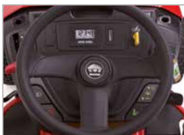
Cruscotto compatto con contatore, indicatore voltaggio batteria e avviso manutenzione
