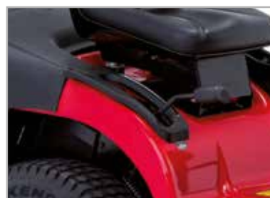
Altezza di taglio regolabile su 7 posizioni da 3,8 ad 8,9 cm
