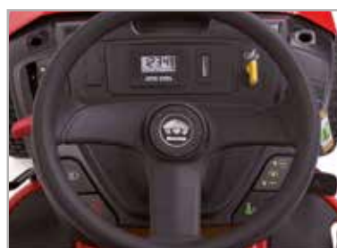
Mini dashboard met urenteller, voltage-meter en onderhoudsindicator
