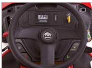
Mini dashboard med timeteller, batteri spenning og vedlikehold påminnelse
