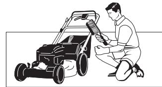
La acumulación de césped y residuos puede provocar un incendio. Asegúrese de limpiar la acumulación de césped y residuos con un cepillo o con aire comprimido, antes y después de la operación.
