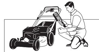
L'accumulation d'herbe et de débris peut causer un incendie. S'assurer de nettoyer toute accumulation d'herbe et de débris avec une brosse ou de l'air comprimé avant et après l'utilisation.
